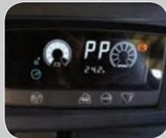
Операторы могут менять рабочие характеристики погрузчика с помощью навигационных кнопок на приборной панели.
