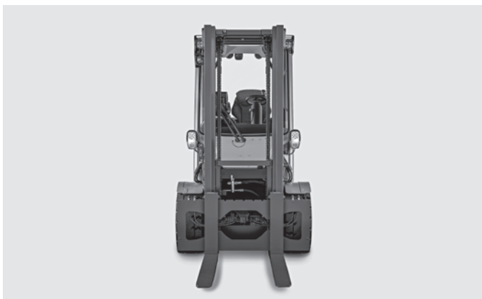
Наивысшая безопасность благодаря узкой грузоподъемной мачте, обеспечивающей превосходную видимость вил
