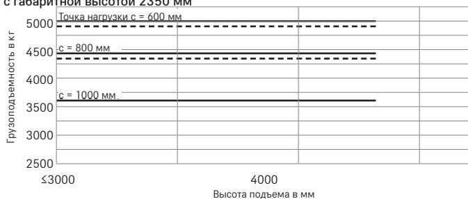
RX 60-50/600 Трехсекционная мачта/Одинарные шины суперэластик с габаритной высотой 2350 мм
