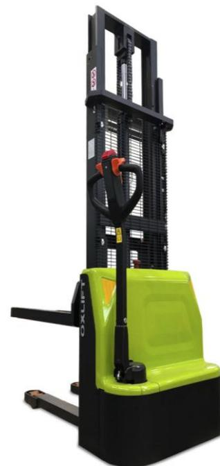
Штабелеры данного модельного ряда имеют малую массу, обладают высокой маневренностью. Высокая надежность ключевых систем и прочная конструкция являются залогом длительной и беспроблемной эксплуатации.
