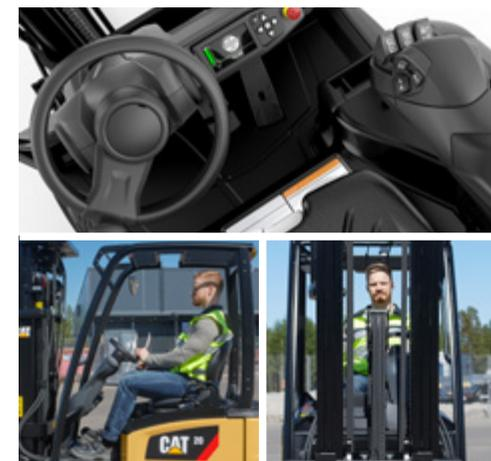
Регулируемое сиденье и рулевая колонка обеспечивают удобную посадку при движении для операторов любого телосложения. Спереди, сзади и сбоку обеспечивается отличный обзор благодаря специальной конструкции цилиндра подъема каретки на доступную высоту, в которой шланги и цепи располагаются таким образом, чтобы меньше препятствовать обзору. Эргономичные органы управления включают в себя регулируемый подлокотник с встроенными рычагами пальцевых манипуляторов и комплект педалей, снижающих усталость.
